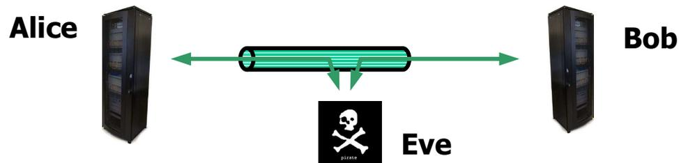
La **autenticación** permite a cada tarjeta comprobar que los mensajes recibidos provienen del interlocutor esperado, mediante la **firma** de estos mensajes.
